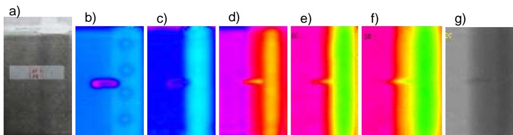
Fig. 10 Coupon no 5: a) view of the coupon, b) ET – 2kHz, c) ET – 4kHz, d) ET – 8 kHz, f) ET – 20kHz, g) ET – 40kHz, h) ET – 80kHz
